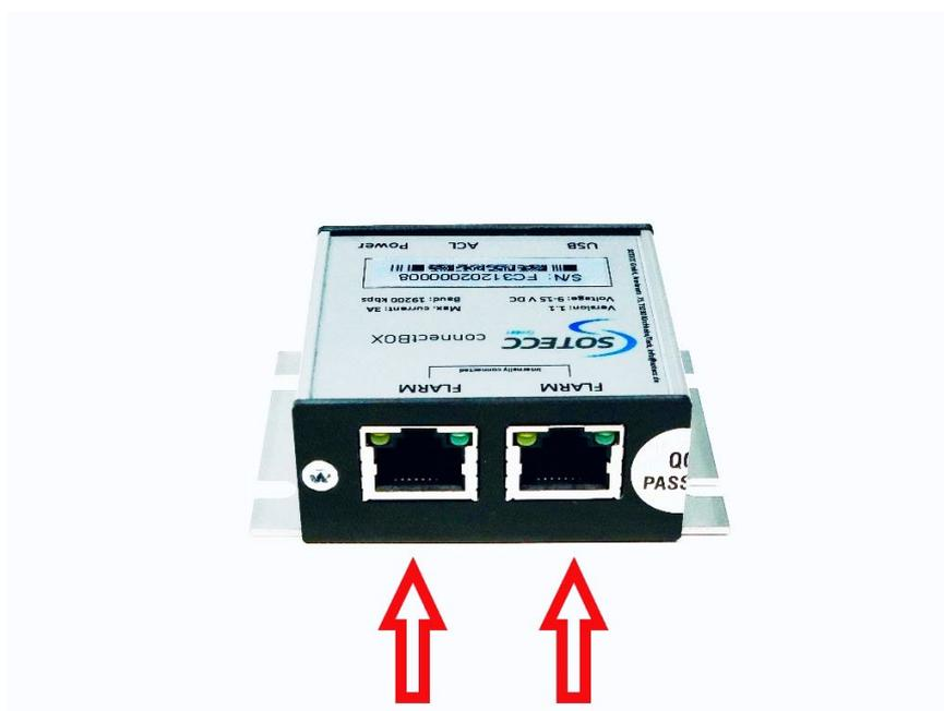
Der ADS-B Empfänger TRX-1090 „Bluebox“ kann nicht zwischen FLARM und der connectBOX eingeschleift werden. Gegebenenfalls das FLARM direkt mit der connectBOX verbinden.
