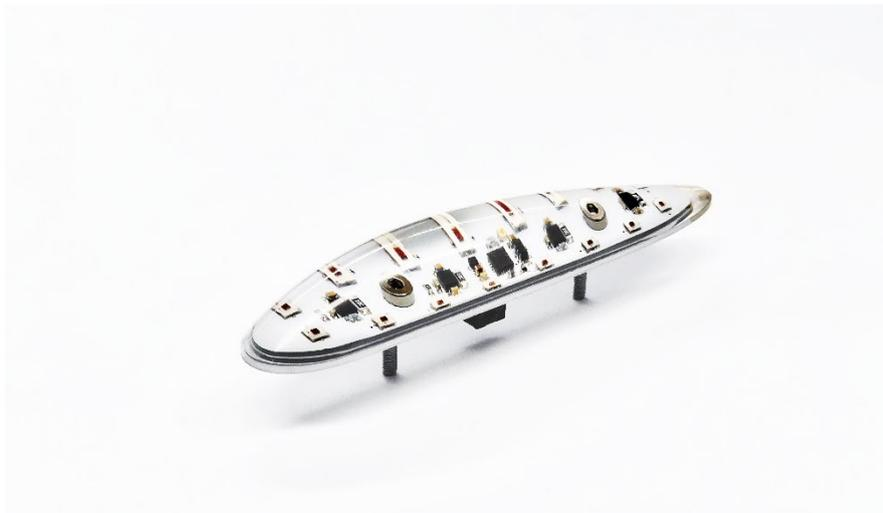
Mit zwei M3 Schrauben lässt sich das Strobe sicher und einfach befestigen. Kleinere Unebenheiten bzw. die Wölbung des Rumpfes werden durch ein 1mm dünnes Schaumband ausgeglichen, damit liegt das Strobe immer plan und flächig an.
