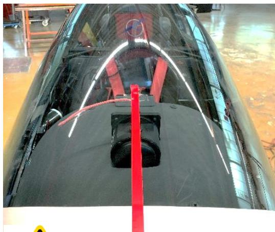
Dazu mithilfe eines Klebebands oder eines dünnen Fadens die Mitte der Haube bestimmen.
