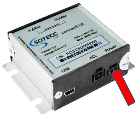
Die ConnectBOX über die mitgelieferte Sicherungs/Schalter Kombi mit dem rot/blau verdrehtem 2-poligen Kabel anschließen (Power-Steckplatz), ggf. Kabellänge anpassen. Den Schalter anschließend mit einem freien und geeigneten Steckplatz des Flugzeug Bordnetz verbinden. Detaillierte Übersicht: [siehe Anhang 1 \(Verkabelung\)](#).
