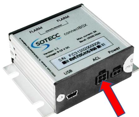
Den 4-poligen Molex Stecker in den ACL-Steckplatz der connectBOX stecken.
