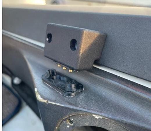
Mit einem 2,5mm Bohrer durch die Schablone in die Lüftung bohren, dann diese mit den mitgelieferten Schrauben provisorisch fixieren. Das Langloch der Schablone ausfräsen. Falls kein Fräser verfügbar: außen mit 7mm aufbohren und das innere größere Loch mit 10mm, ggf. mit einer Rundfeile passend schleifen. Dann Schablone abschrauben und entsorgen.
