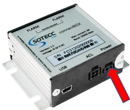
Die ConnectBOX über die mitgelieferte Sicherungs/Schalter Kombi mit dem rot/blau verdrehten 2-poligen Kabel anschließen (Power-Steckplatz), ggf. Kabellänge anpassen. Den Schalter anschließend mit einem freien **und geeigneten** Steckplatz des Flugzeug Bordnetz verbinden. Detaillierte Übersicht: [siehe Anhang \(Verkabelung\)](#).
