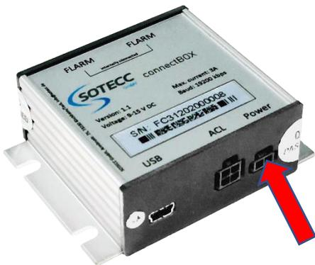
Die ConnectBOX über die mitgelieferte Sicherungs/Schalter Kombi mit dem rot/blau verdrehten 2-poligen Kabel anschließen (Power-Steckplatz), ggf. Kabellänge anpassen. Den Schalter anschließend mit einen freien **und geeigneten** Steckplatz des Flugzeug Bordnetz verbinden. Detaillierte Übersicht: [siehe Anhang \(Verkabelung\)](#).
