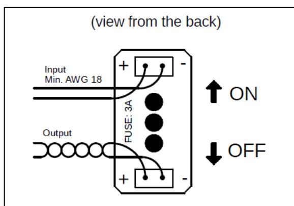
An geeigneter Stelle im I-Brett ein 6mm Loch bohren. Kabel ablängen und am Schalter anschließen. Polarität am Schalter beachten. Plus+ (rotes Kabel) auf der linken Seite anschließen. Wir empfehlen die Verwendung von Aderendhülsen.
