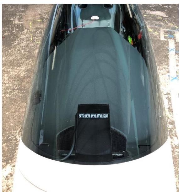
Dazu mithilfe eines Klebebands oder eines Fadens die Mitte der Haube bestimmen.
