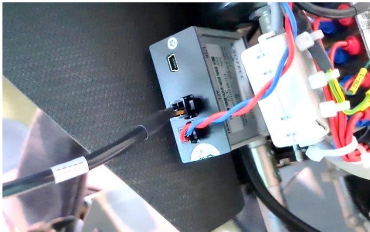
Abschließend mit RJ45 oder RJ12 Kabel das FLARM® mit der connectBOX verbinden.
