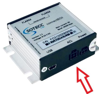
ConnectBOX an eine freie Sicherung (3-5 A) des Segelflugzeug Bordnetzes mit dem rot/blau verdrehtem 2-poligen Kabel anschließen (Power-Steckplatz), ggf. Kabellänge anpassen. Der Schalter für manuelles Ausschalten des Stobes kann zwischen das Stromkabel gesetzt werden.
