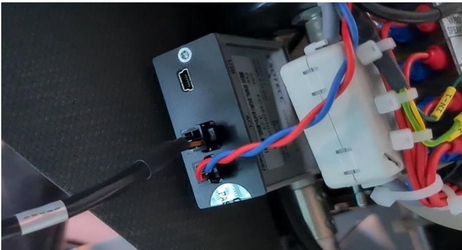
Kabel zum Haubenblitzer oben (ACL), Verbindung zum Bordnetz unten (Power).
