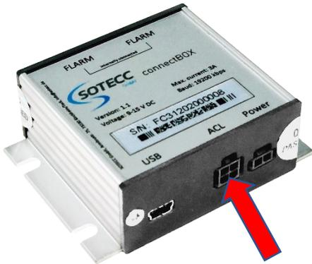
Das 4-polige Kabel des Gegenstücks (in der I-Brett Abdeckung, siehe Arbeitsschritt 4, letztes Bild) in den ACL-Steckplatz der connectBOX stecken.
