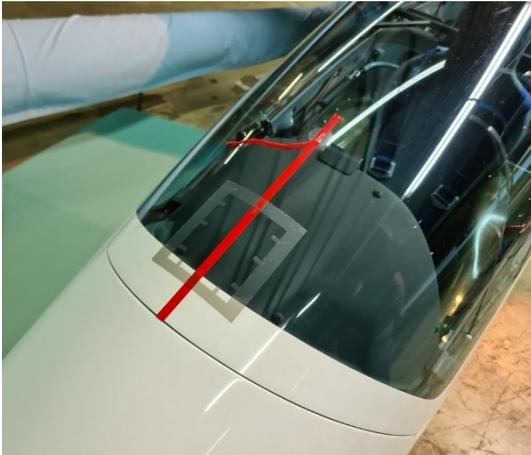
Die vorderen Abstandshalter der Schablone müssen ca. 1mm hinter der Lackkante (Richtung Leitwerk) platziert werden.
