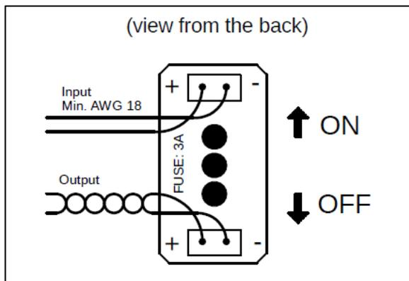
An geeigneter Stelle im I-Brett ein 6mm Loch bohren. Kabel ablängen und am Schalter anschließen. Polarität am Schalter beachten. Plus+ (rotes Kabel) auf der linken Seite anschließen. Wir empfehlen die Verwendung von Aderendhülsen.
