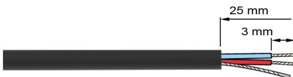
Die zwei TX8 Schrauben aus dem Haubenkontakt heraus-schrauben. Federkontakte mit Halterung entnehmen. Kabel durch das seitliche Loch im Haubenkontakt schieben. Dann wie abgebildet verlöten, mit Schrumpfschlauch isolieren und wieder mit dem Haubenkontakt verschrauben.
